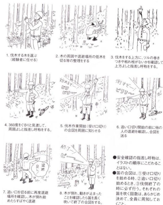
図5—伐倒作業の安全確認
